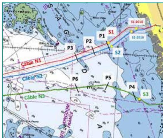
Fig.9 : Positions des profils (P1 à P6) et stations (S1 à S3) prévues initialement pour mesurer les champs électromagnétiques avec l'outil PASSEM, au niveau de la connexion Jersey-Cotentin comprenant les câbles N1, N2 et N3.
