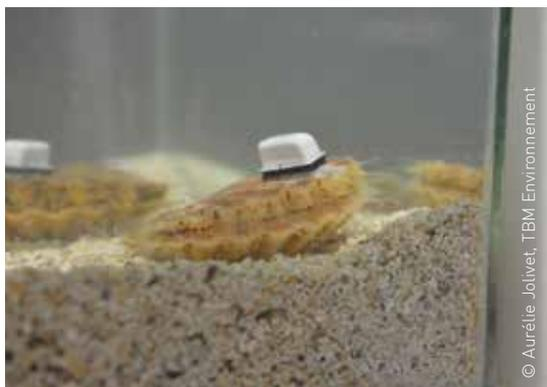
Fig. 43 : Fixation des accéléromètres sur les coquilles Saint-Jacques.
