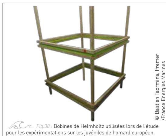
Fig.38 : Bobines de Helmholtz utilisées lors de l'étude pour les expérimentations sur les juvéniles de homard européen.
