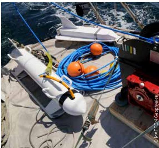
Fig. 5 : Aperçu de l'outil PASSEM sur le pont avant déploiement.
