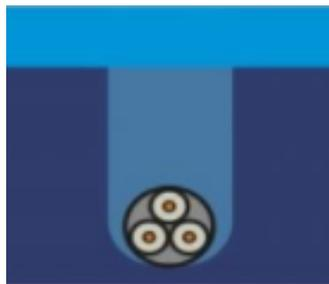
La deuxième technique s'appelle l'enrochement. Le câble est posé sur le sol puis est recouvert par de la roche. Cette technique permet aussi de créer un nouvel habitat pour la faune.
